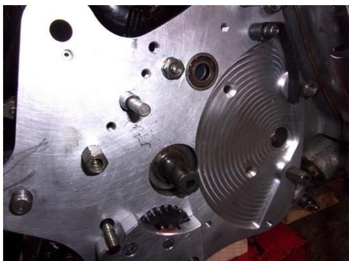
Toutes les pièces venues avec la G50 doivent être remontées sur la nouvelle, y compris le roulement du changement de vitesses et la bague du kick.
