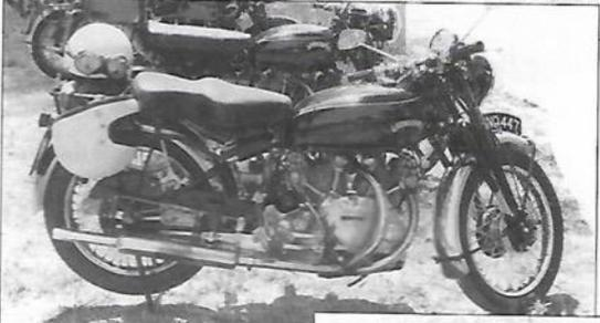
Ci-contre : encore une Vincent équipée de carburateurs Amal Concentric pour en faciliter l'utilisation, le démarrage et le ralenti en particulier.
