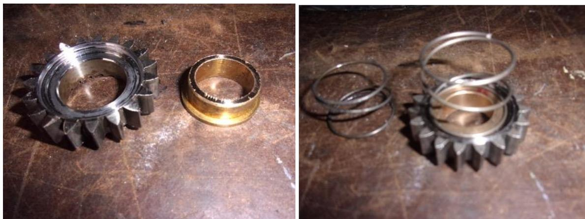
*Le rochet original (G46) doit être réduit en épaisseur et évidé. La bague bronze doit être tournée pour être à ras à l'arrière du pignon L'évidement doit être assez large pour accueillir le ressort G48.*
