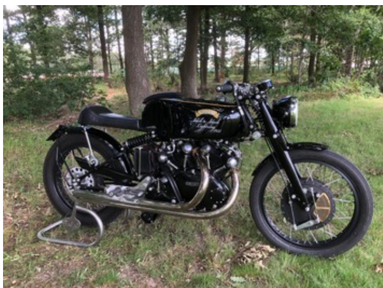
La très spéciale Egli-Vincent "Black Lightning", avec des freins de course Fontana en magnésium
