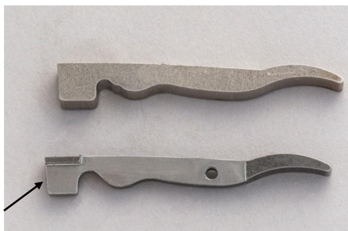
L'usinage de la palette nécessite une précision extrême (de l'ordre du centième) pour assurer un fonctionnement parfait. Cet usinage est une spécialité des Ets Maubert Usinage.
