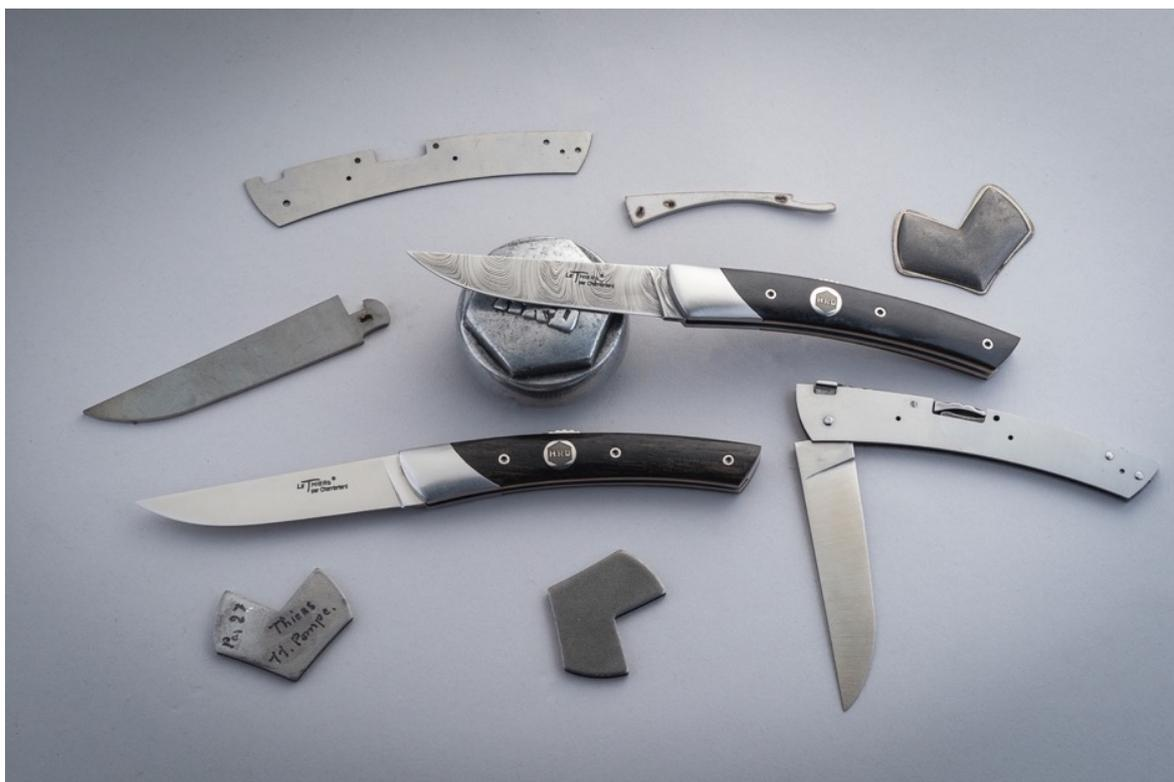
Une autre vue d'une partie des éléments constitutifs. Les formes en V sont les mitres, d'abord forgées, puis découpées en deux parties avant d'être soudées sur leurs platines respectives. Elles seront polies lors de la finition.
