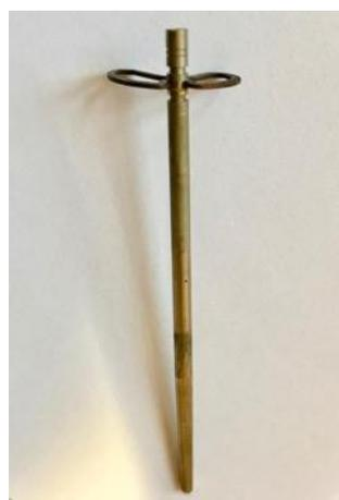
**Réglages d’aiguille.** Il n’y a guère qu’une seule possibilité : la hauteur de l’aiguille, ce qui ouvre ou ferme plus ou moins le cône. Cela se fait simplement en déplaçant l’épingle dans l’un des gorges ce qui remonte ou abaisse l’aiguille.
