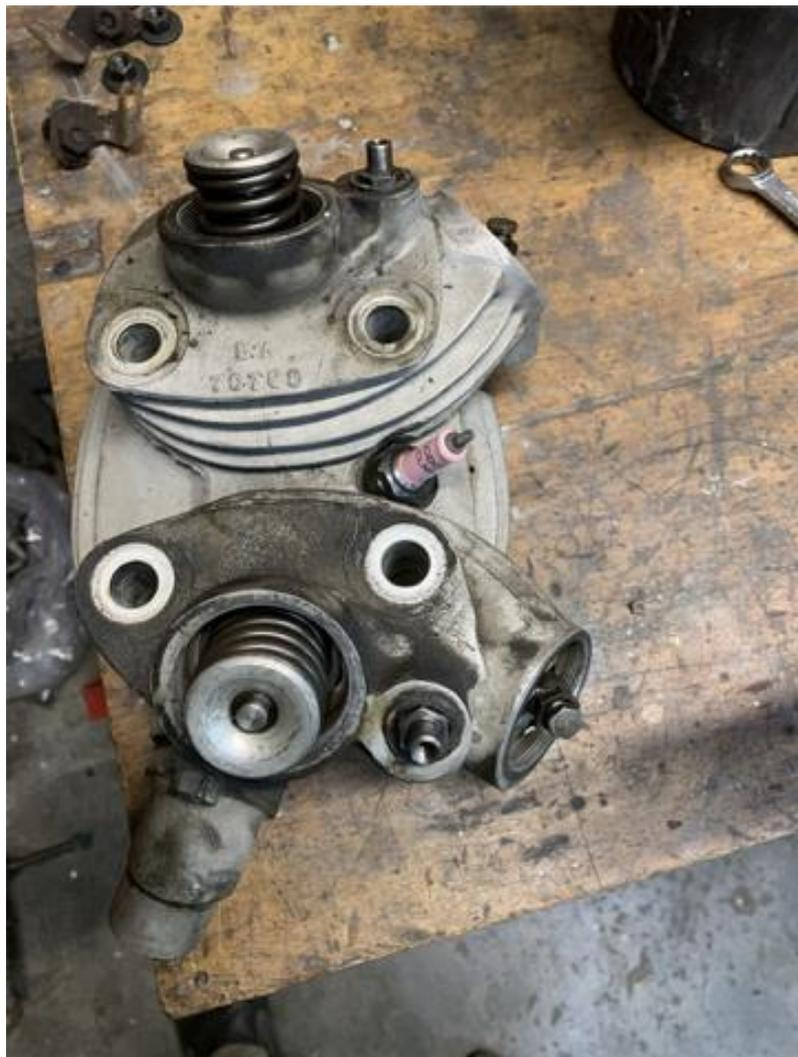
Il va falloir mesurer le jeu entre les guides et les soupapes et refaire, par précaution, les deux culasses, bien que la coupable soit celle avant.
