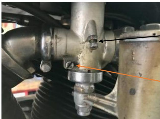
Tous les modèles de carburateurs ont 2 vis de réglage sur le côté.
