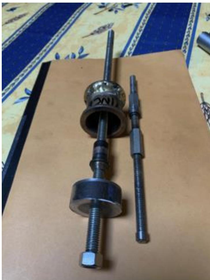
La méthode préconisée, et la meilleure, est de préchauffer la culasse à 200°C (four familial, après le rôti) et de faire un outil qui permette d'extraire puis de positionner le guide parfaitement en ligne dans son logement au remontage.
