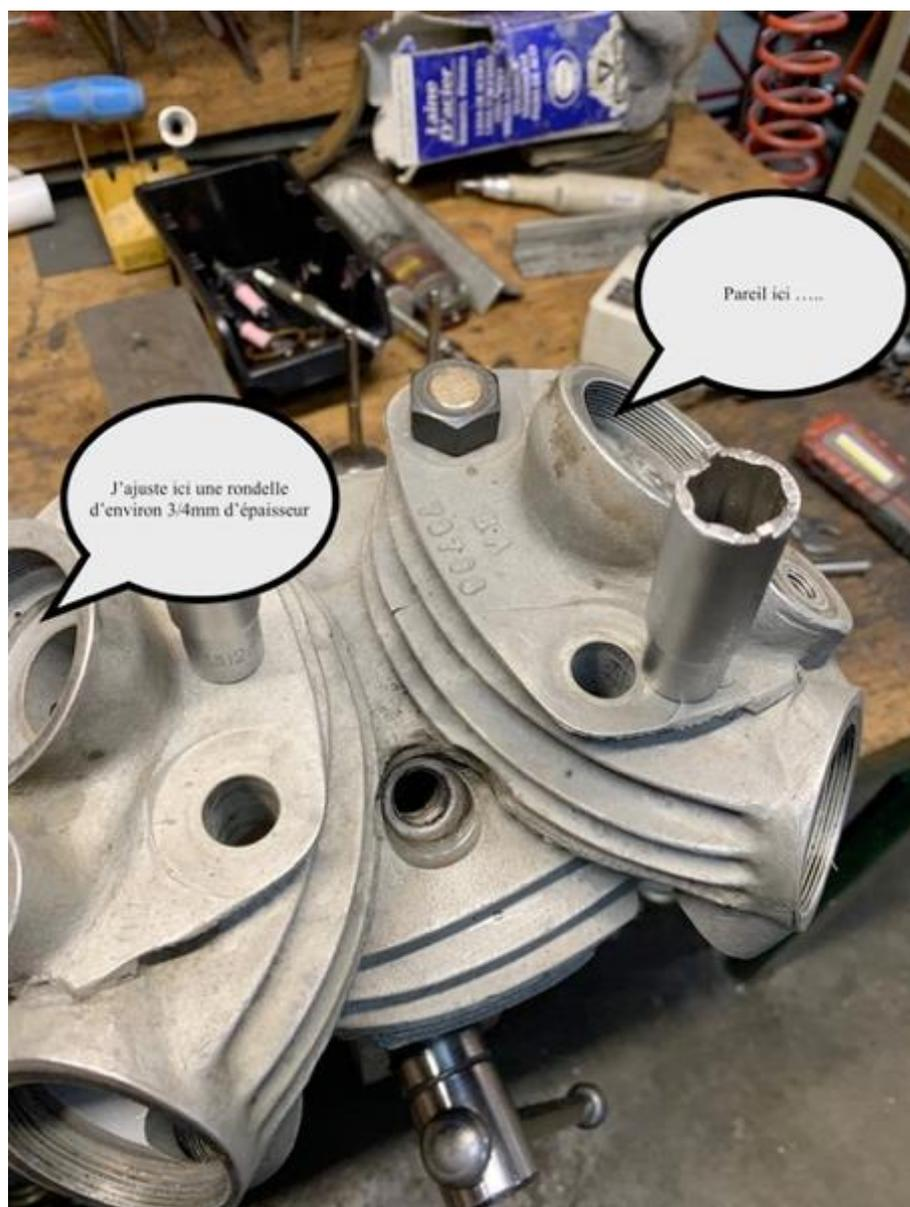
**À noter :** la culasse est maintenue dans un gros étau (on voit l'un des écrous surmontant l'une des tiges filetées) pour permettre de la maintenir pendant les opérations de démontage et de montage des guides.
