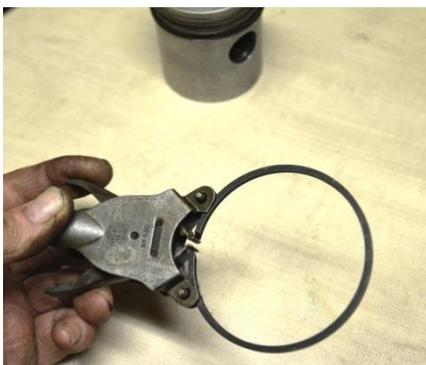
Le segment est réalisé en métal très dur, anciennement en fonte, il doit être élastique pour épouser parfaitement la courbe du cylindre.
