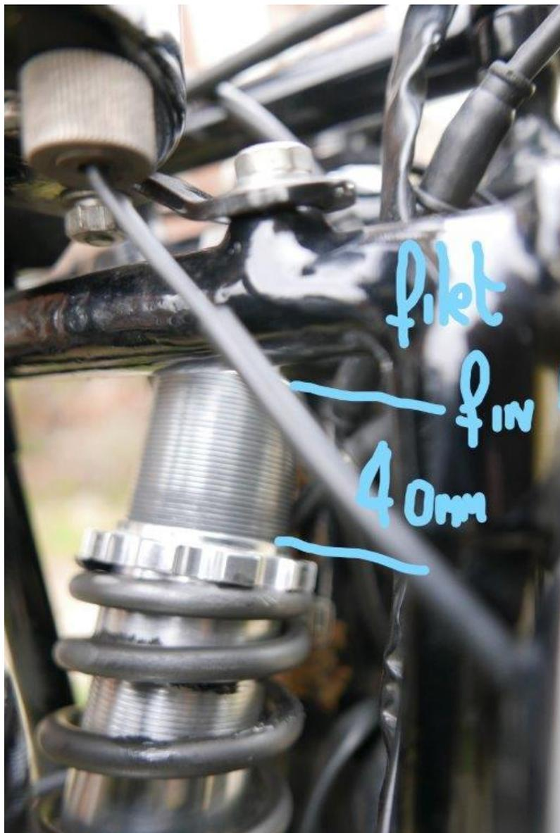
maxi de l'amortisseur reprise des manivelles et taillage de la chape monobloc en acier. Vers 13h00 l'ensemble est posé sur la moto, l'amortisseur fonctionne, il arrive en butée, reste à régler la précontrainte du ressort.
