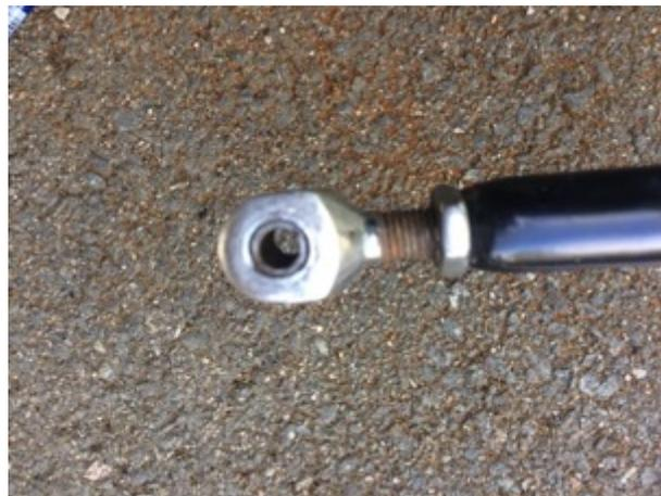
Extrémité du haut : fabriquer et souder (ou braser) un insert fileté BSF 5/16 pour recevoir la douille de selle Ref FT111 et son écrou Ref 558.
