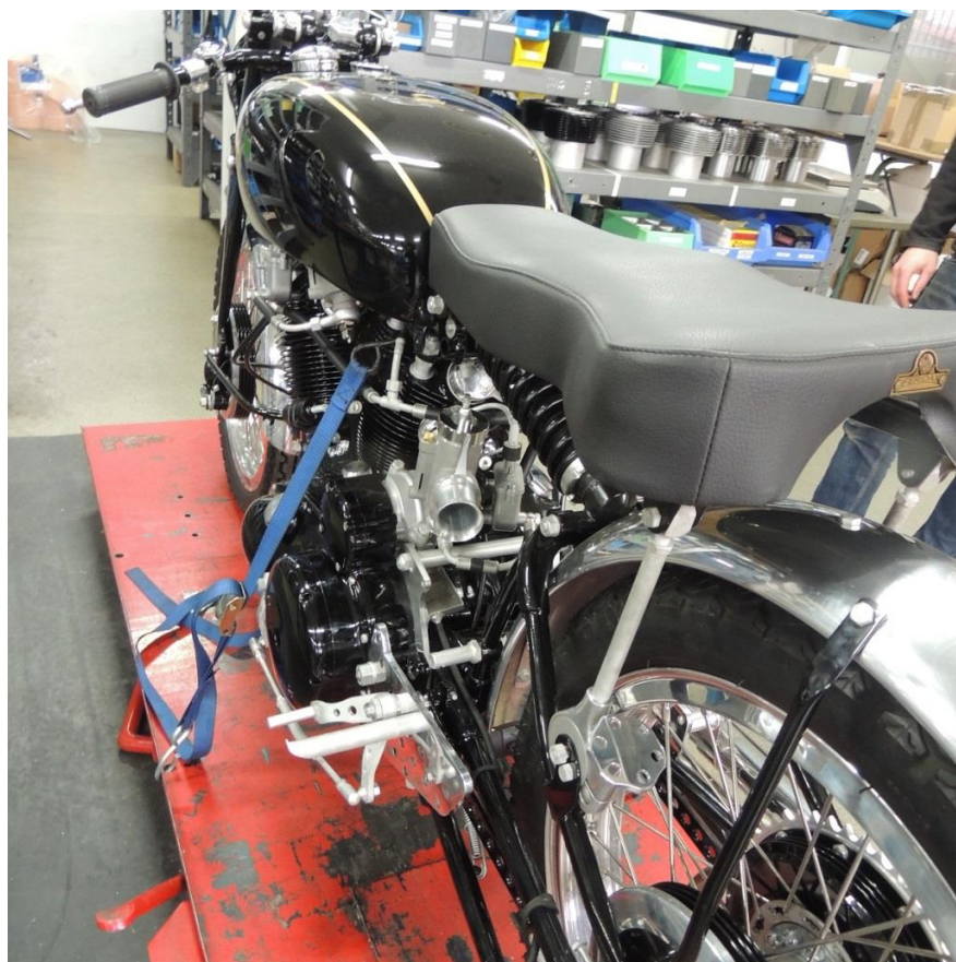
Vue de l'arrière, avec les carburateurs, la selle provisoire, le renvoi de sélection placé à gauche.
