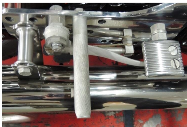
Pédale de frein à droite et repose pied réalisé à l'identique.
