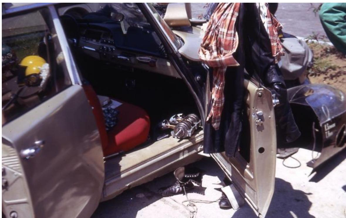
**Sur cette vue de l'intérieur de la Citroën (un modèle de la fin des années 60 avec le 2<sup>ème</sup> tableau de bord) le lecteur remarquera la commande de vitesses hydraulique... Ce dispositif sur un break est rarissime, le Loup-Garreau ignorait même qu'il exista !**
