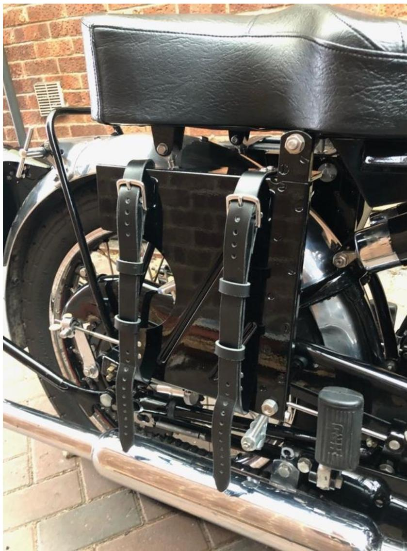
**Sur cette vue, nous apercevons la tôle arrière (en aluminium) contre laquelle la sacoche va venir s'appuyer ainsi que les courroies de maintien.**
