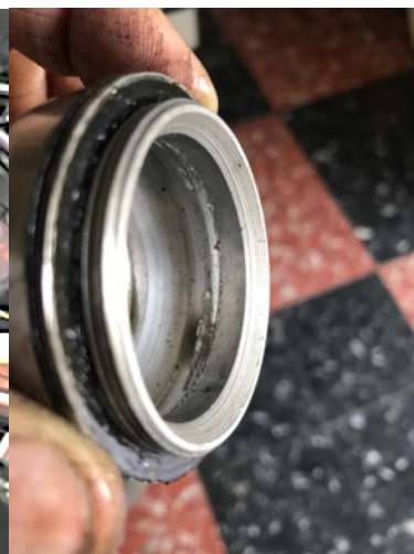
Bouchon rayé lors d'un essai de desserrage culbuteur levé
