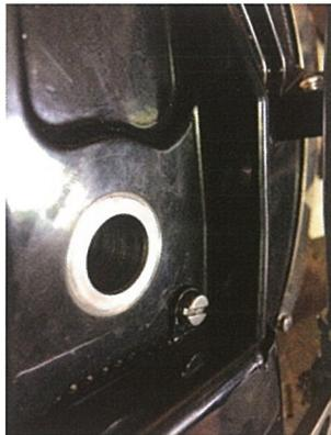
Régler les jeux des roulements pour assurer avec des cales un léger dépassement des flasques pour que les bras soient bien en appui sur l'axe et non pas sur les flasques. Les cales sont les mêmes que celles d'origine et sont fournies dans le kit.
