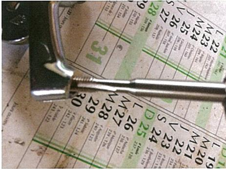
Les freins sont commandés par deux câbles via un dédoubleur installé en bout de levier d'origine. Filetage (M6) du levier d'origine pour installer le dédoubleur, qui est juste tenu par un boulon M6.
