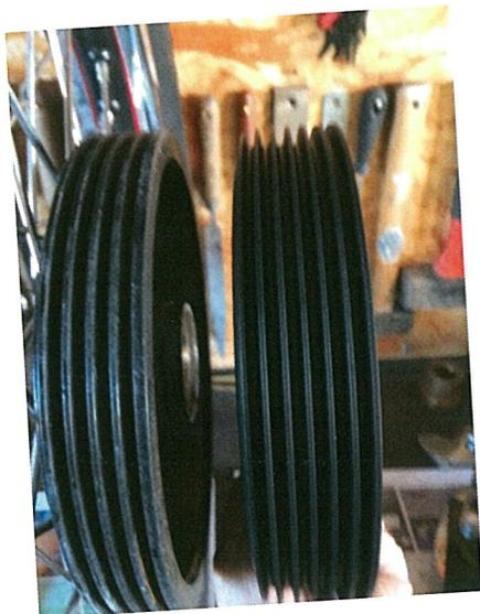
Le poids du frein complet est légèrement inférieur (50Gr selon mes mesures) au frein d'origine, malgré des tambours plus larges et des platines (alliage) autrement plus épaisses et plus rigides. L'usinage est de très grande qualité, les jeux réduits au maximum : du beau travail !
