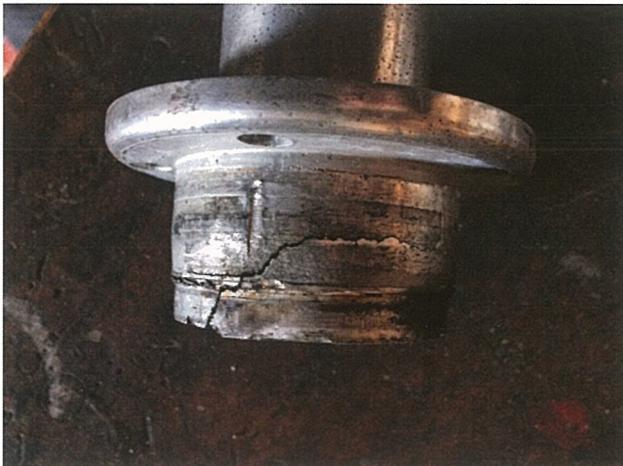
Bien sûr, la Comet de Rachel est équipé de roulements larges (ref H22)... En démontant les cages de roulement malgré un chauffage soigné et beaucoup de douceur, le moyeu alu d'origine casse...
