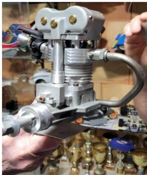
Parmi les centaines de maquettes et de moteurs réalisés, André nous montre un monocylindre de 20 cm<sup>3</sup> à quatre soupapes commandées par un double arbre à cames en tête entraîné par couple conique.
