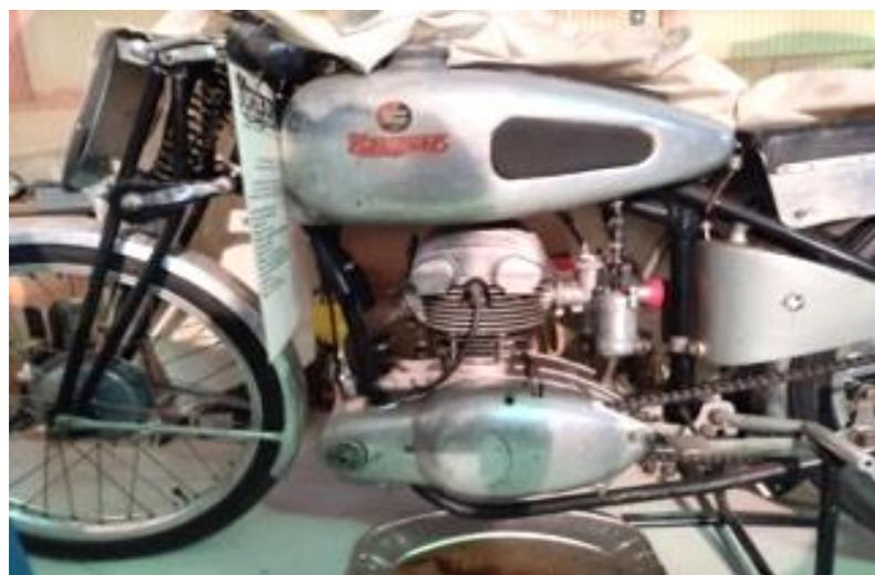
**- 1949.** Sur la base du bloc moteur 125 culbuté, une moto « compé-client » a été développée, à la demande, et pour l'usine Terrot. Troisième palier de vilebrequin. Boîte 5, 130 km/h à 8000 rpm. Fourche parallélogramme puis télescopique. Pour Terrot, le prototype est jugé trop cher et ils ne donnent pas suite.
