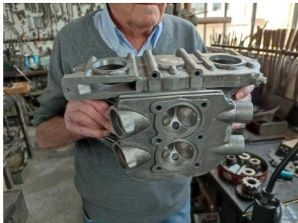
**Ci-dessus, dans l'atelier, André nous montre la dernière version, taillée dans la masse, du vilebrequin 4 cylindres et la magnifique demi-culasse du 4 cylindres. L'angle des soupapes est 90°**
