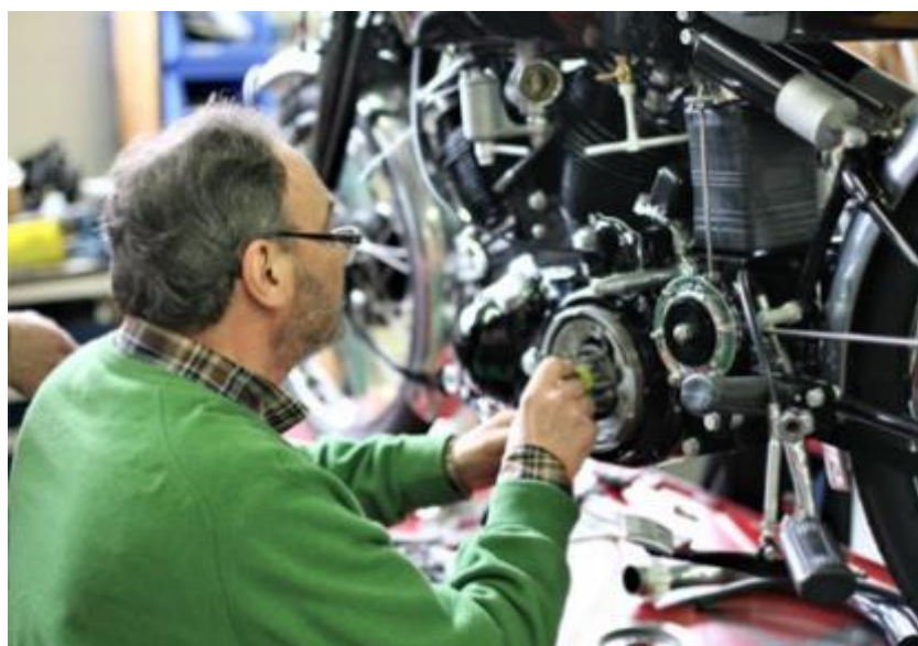
Sur cette photo, l'embrayage primaire est déposé et on voit le mécanisme encore engagé dans le tambour.
