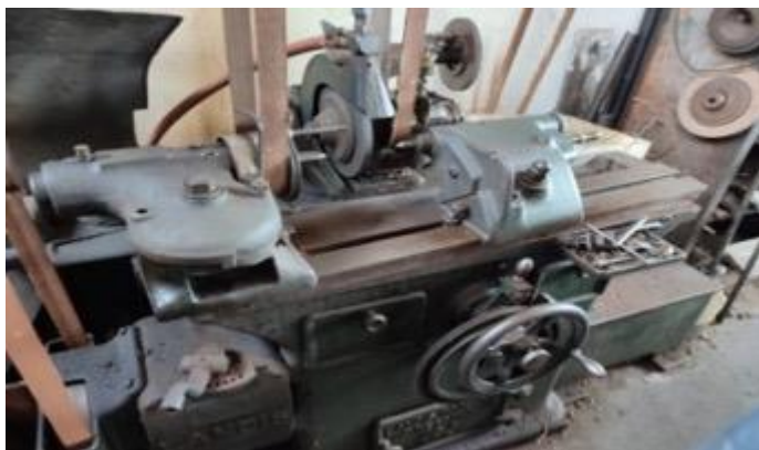
La très vieille rectifieuse « inter/exter » qui permet aussi de rectifier conique car le plateau est orientable sur le plan horizontal (comme c'est le cas sur la photo)
