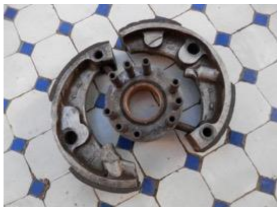
La pièce (C13) entraînée par l'embrayage primaire tourne libre (bague) sur l'axe de boîte et écarte les segments par la poussée des biellettes (C10)
