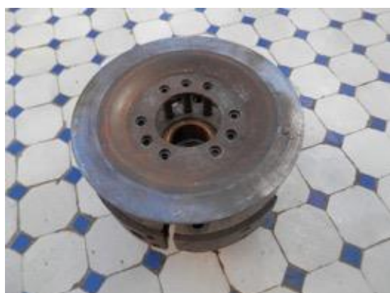
Le plateau récepteur du disque d'embrayage est solidarisé à la pièce C13 qu'il entraînera en rotation
