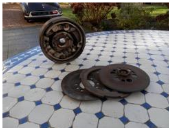
L'embrayage primaire qui va entrainer l'embrayage principal.
