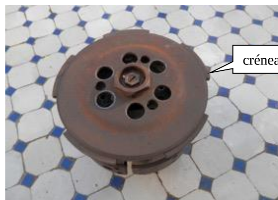
Le plateau de poussée plaque le disque d'embrayage primaire sur le plateau récepteur de la photo précédente (on voit émerger de l'assemblage les « créneaux » du disque racing.
