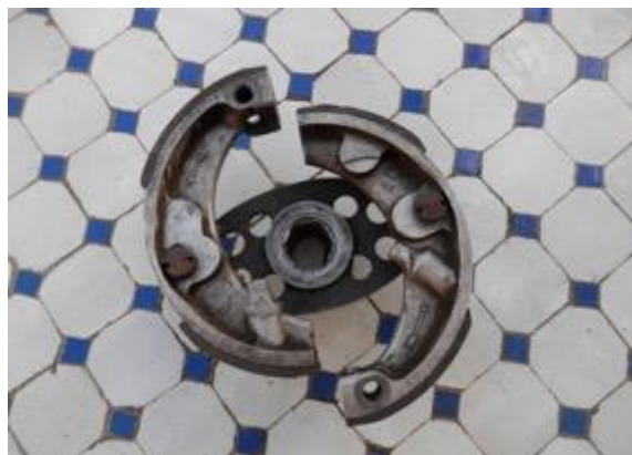
Les segments sont fixés sur une pièce en forme de fuseau (C3) solidaire de l'axe de boîte (cannelures)
