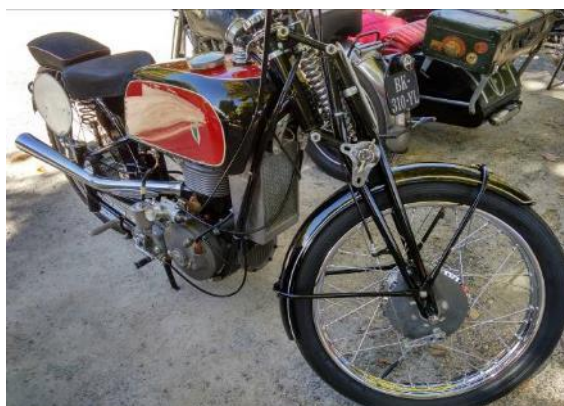
Une DKW grand prix d'avant-guerre, deux temps avec piston pompe, neuve
