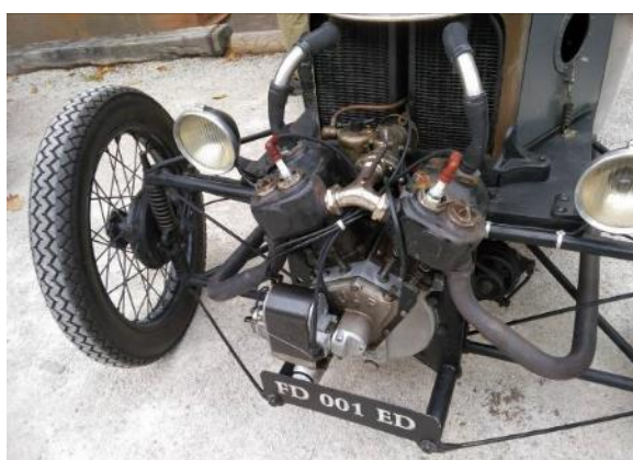
Cyclecar MORGAN avec un moteur JAP ; le rapport poids/puissance est très favorable
