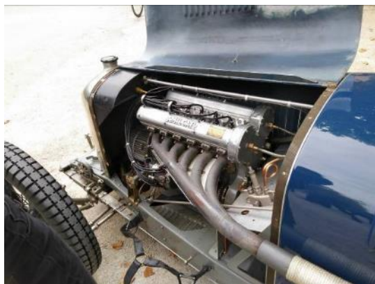
AMILCAR C6 de 1927; 6 cylindres, double arbre, plus un compresseur
