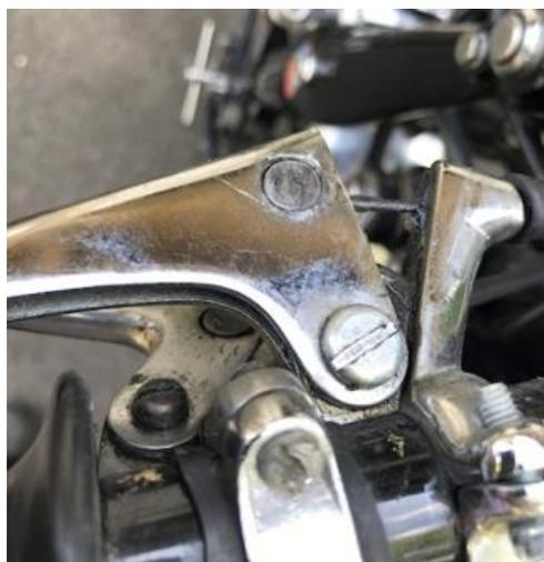
Vérifier au niveau du levier que le câble n'est pas effiloché, c'est en général là que cela peut commencer. Il est conseillé de graisser la boule dans le levier (celle-ci doit tourner un peu lors de l'action sur le levier sinon il va se créer les amorces d'effilochage du câble).
