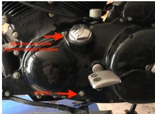
Donc ne mettre que le minimum (1 à 2 cm de hauteur) pour que le bas des rouleaux de la chaîne trempe. Cela suffit largement à sa lubrification par les abondantes projections créées par la rotation de la chaîne.
