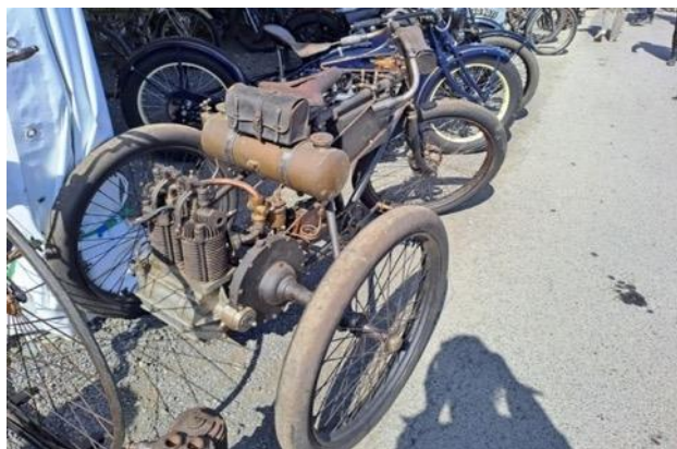
Tricycle Buchet de course Il est propulsé par un bicylindre de 1100 cm 3
