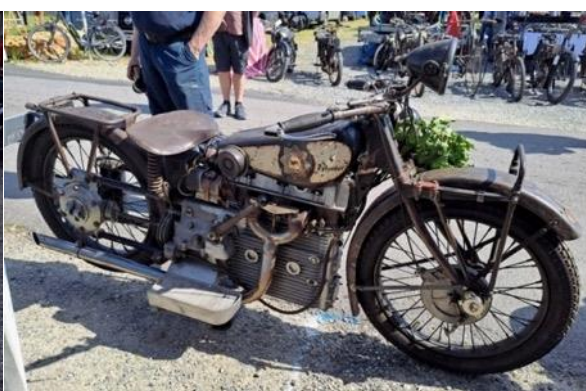
750 Windhoff 1929 4 cylindres refroidis par huile
