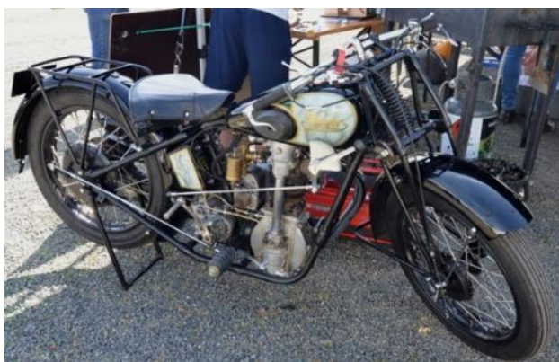
350 Soyer 1930 Type 08 Moto française avec arbre à cames en tête
