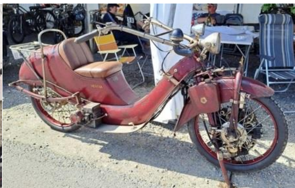
640 Megola 1923, cinq cylindres en étoile, dans la roue avant
