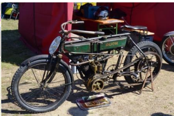
1000 Puch 1906 ; ce n'est pas un deux temps mais un bicylindre 4 temps
